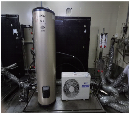
图 7 家用空气源热泵热水器实验测试
