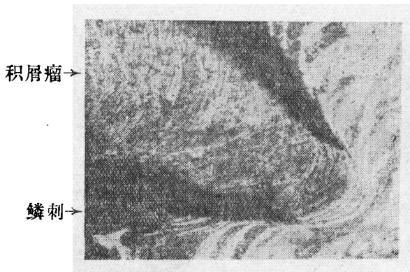
图 8 有积屑瘤时产生鳞刺(后刀面积屑层)的情况 ( \times 400 ) r_f = r_0 = 0^\circ , v = 20 \text{ mpm} , 自由切削, 高速钢刀具, 45 号钢, 干切削, f = 0.08 \text{ mm pr.}
