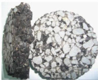
图4 劈裂试验试件破坏面
