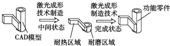
图 1 采用激光成形技术制造功能零件示意图
