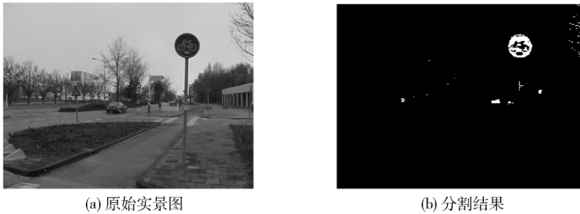
图 3 基于 RGB 视觉模型的交通标志分割结果
