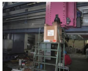
图 10 安装完整横梁的模态实验
