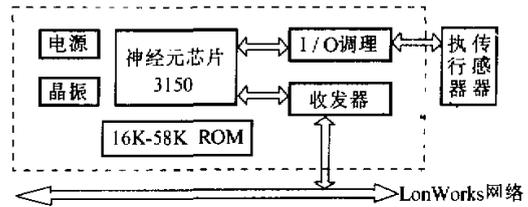
图2 硬件结构图
