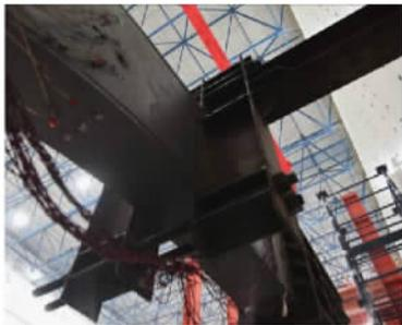
图 21 XQL-2 构件面外支撑
