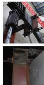
图 29 XQL-3 构件面外支撑
