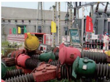
图11 汶川地震中某 110 kV 变电站损坏的开关<sup>[43]</sup>
