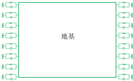
图 2 黏弹性边界条件示意图
