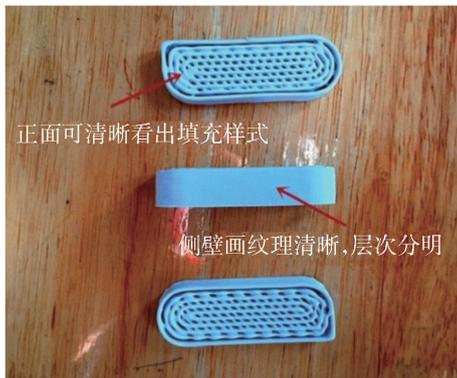
图 7 先驱体陶瓷零件
