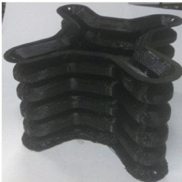
(c) 利用TPU材料通过3D打印得到的柔性臂外壳成品
