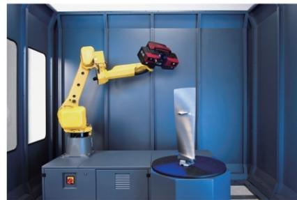
图6 基于结构光投影法的叶片测量机
