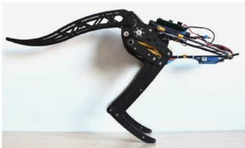
图 1 仿袋鼠机器人机构实物
