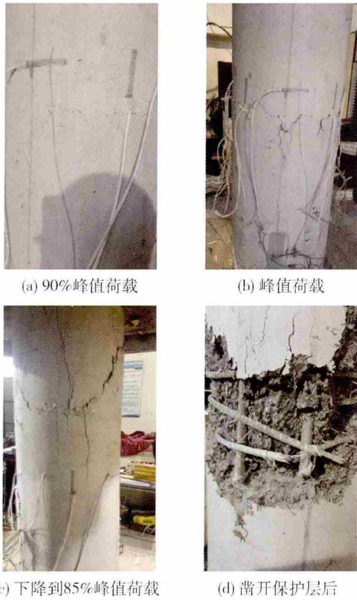
图3 试件在不同加载阶段的开裂现象(G6-50)
