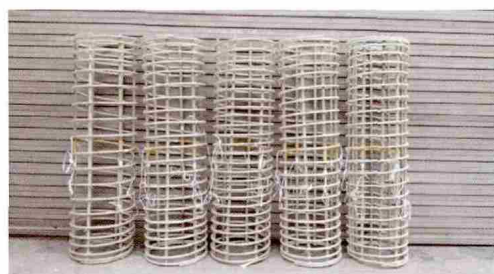
(b) 绑扎好的GFRP筋
