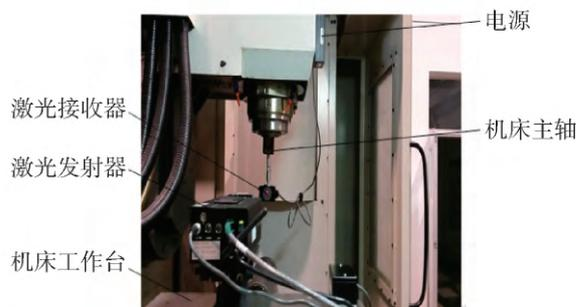
图3 激光干涉仪安装
