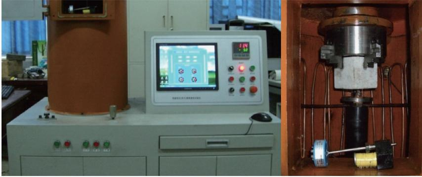
图1 低温低压摩擦磨损试验机实物
